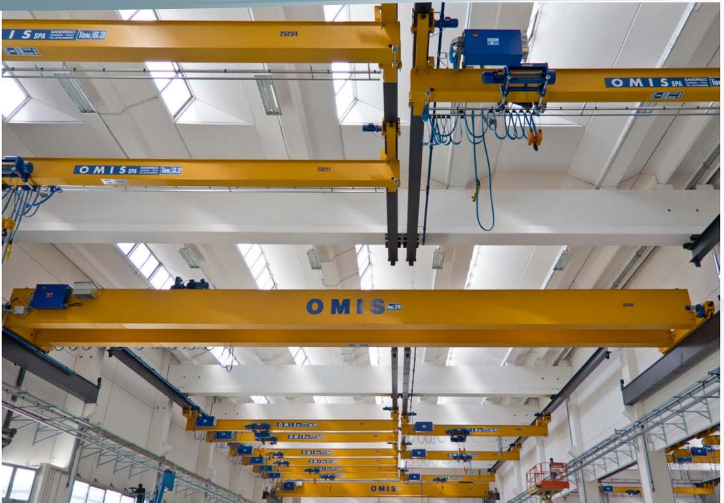
OMIS est la société leader sur le marché italien du pont roulant standard, d'une capacité allant jusqu'à 20t et une portée maximum de 25 mtr. OMIS conçoit également des ponts roulants sur mesure de capacités et portées variables.
