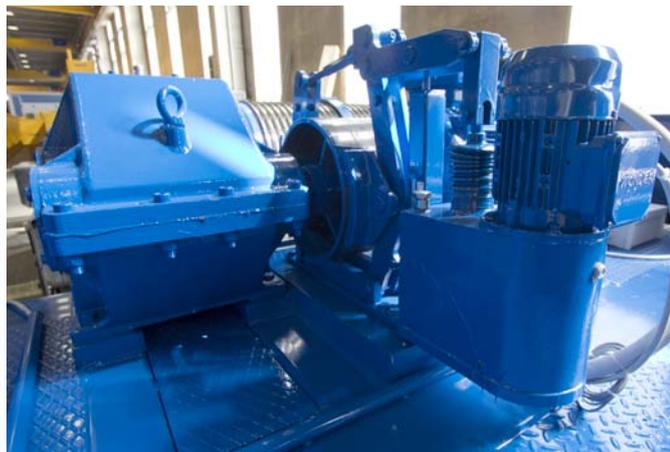
Chaque treuil est composé d'un réducteur principal à deux ou trois étages de réduction relié à un moteur asynchrone à trois phases de type court-circuit.
